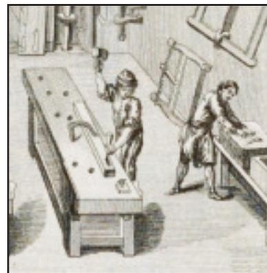
**Banco da falegname** (ingl. *woodworker's Bench*), è il primo ed il più importante tra gli attrezzi che non modificano l'oggetto lavorato ma lo tengono fermo ed in posizione comoda e sicura in modo da permettere le operazioni di taglio, piallatura, foratura con entrambe le mani.
