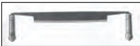
piatta o curva fornita di due manici, impiegato per dare l'ultima forma agli alberi e alle antenne. Si è trovato in cantieri navali di vichinghi del primo secolo a.c. ed è riportato nelle tavole dell'*Encyclopédie* di Diderot (Parigi 1763). Ha trovato impiego fino alla fine degli anni 60 del secolo scorso. Osservando come il carpentiere utilizza questo strumento si comprende il particolare nome che gli viene assegnato.
