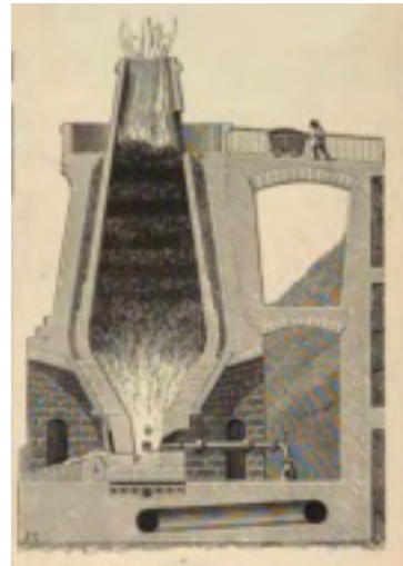
Forno per la produzione indiretta di acciaio - da Popular Encyclopedia - London 1875.
