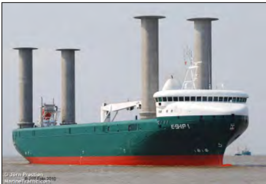
La "E-Ship 1" della Enercon con i rotori Flettner.
